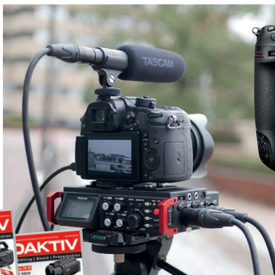
TASCAM BRINGT EIN KAMERAMIKROFON mit XLR-Anschluss. Das TM-200 SG passt an entsprechende Filmkameras oder (wie hier) DSLR-Recorder.
